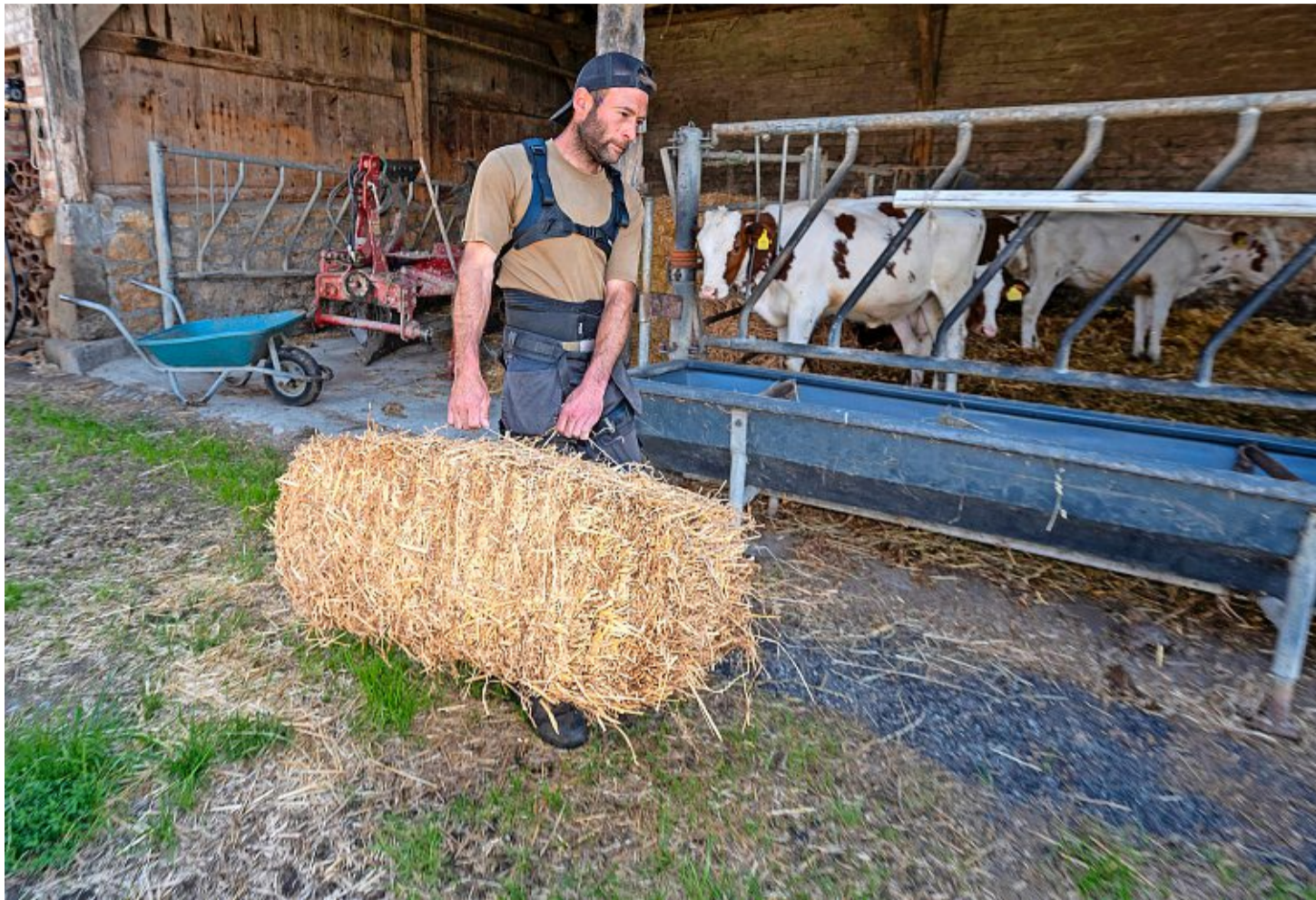
L'exosquelette passif de Florian Etter n'a rien de l'attirail à la Robocop des modèles motorisés dit «actifs». PATRICK MARTIN
